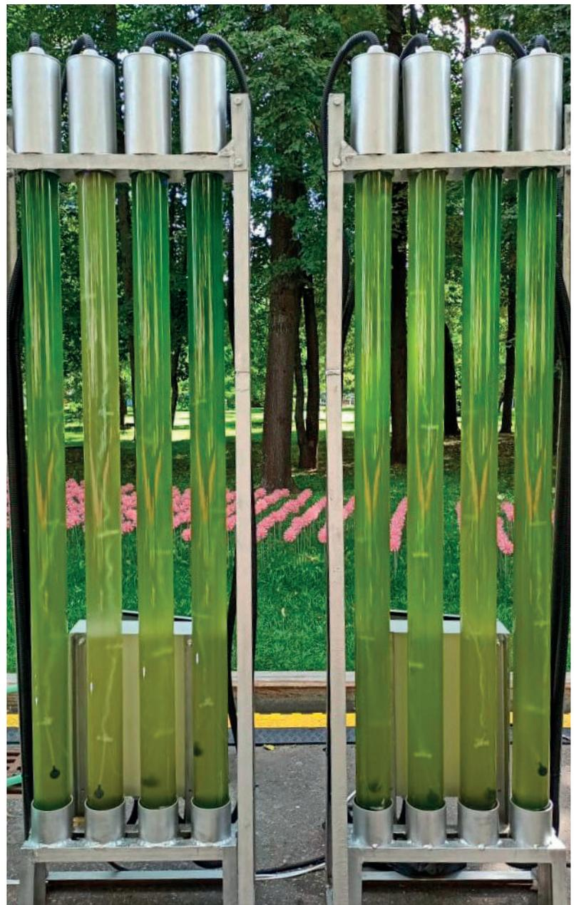
Рис. 13. Фотобиореактор (опытно-экспериментальный образец, НИЦ «Курчатовский институт», выставлен на Московском урбанистическом форуме – 2023)
