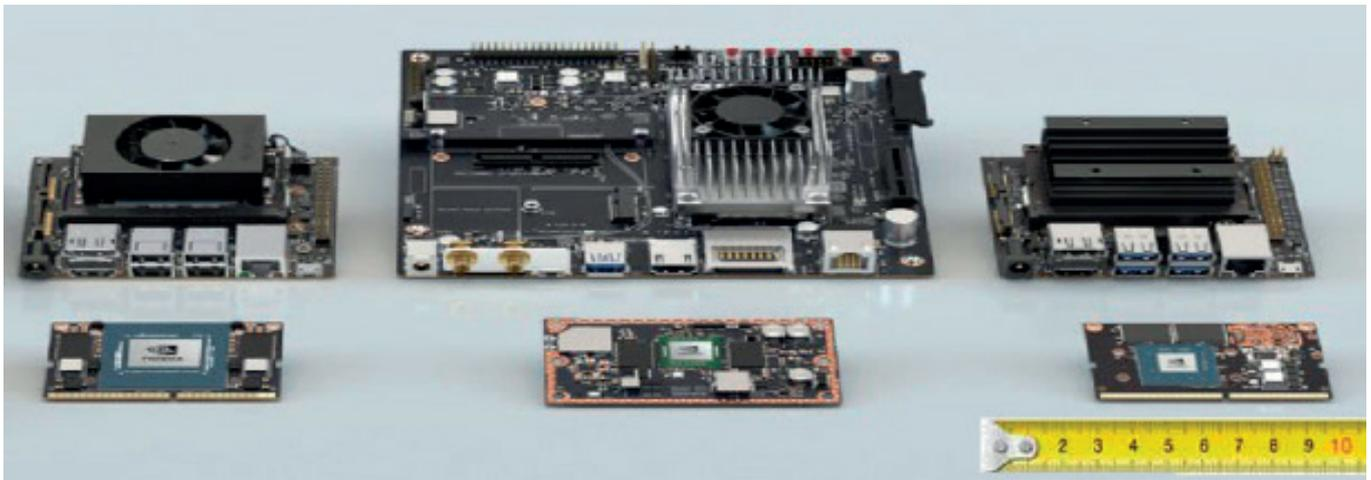
Рис. 87. Различные варианты вычислителей для роботов
