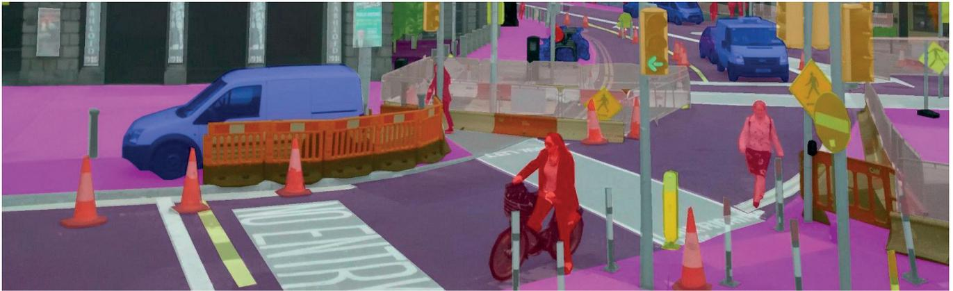
Рис. 94. Работа системы технического зрения по распознаванию окружающей среды (<https://datafloq.com>)
